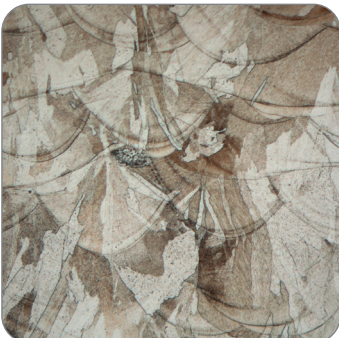
Schliffanalyse generativ gefertigter Bauteile
